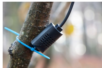
Figure 3 : le capteur de température et d'humidité de l'air est à placer à 2 m de hauteur sur le côté nord de l'arbre.
