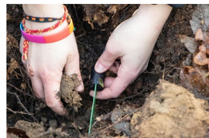
Figure 4 : le capteur qui mesure la température et l'humidité du sol doit être enterré à 20 cm dans le sol.
